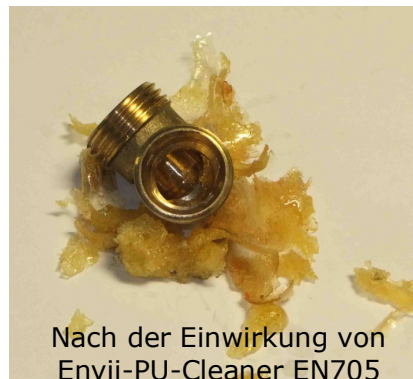
Mit PU-Resten verschmutztes Anlagenteil
