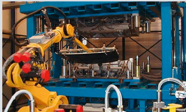
Bild 7: Beheizte Vorrichtung zum Kleben eines Kofferraumdeckels
