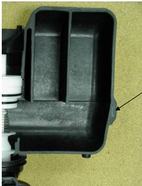
Abb. 8: Querschnitt des Flushmate® Druckbehälters mit dem Nut-Feder-Flansch
