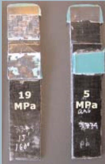
Bild 9: Versagensbild bei der Verklebung von Organoblechen. Links mit nachfolgender Wärmebehandlung, rechts ohne Wärmebehandlung.
