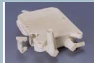
Bild 11: Bremsflüssigkeitsbehälter, PA 6 mit 33 % Glasfaser, 4 druckdichte (4,8 bar) Verbindungen
