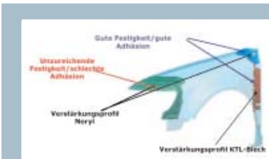
Bild 8: VW Phaeton Kotflügel – Bereiche mit guter und solche mit mangelnder Klebstoffhaftung – Korrelation mit dem jeweils vorliegenden polaren Anteil der Oberflächenspannung /6/ (Grafiken: VW AG)
