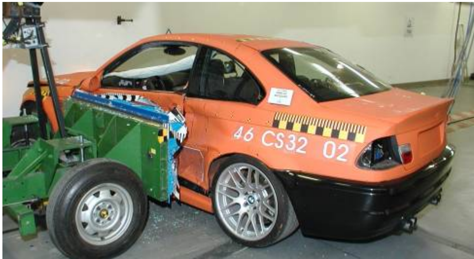
Bild 13 Seitencrash am M3 CSL
