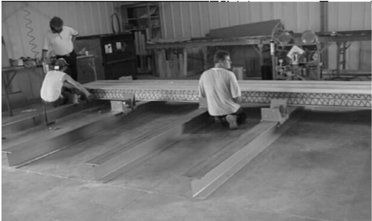
Abb. 6: Herstellung der Superdeck™ -Elemente im Werk
